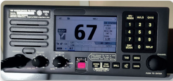
Görsel 2.10: VHF Kanal 67
