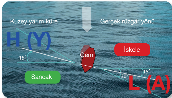
Şekil 1.18: Kuzey yarım kürede rüzgârı kıçtan alan bir gemide yüksek ve alçak basınç merkezinin yön tespiti
