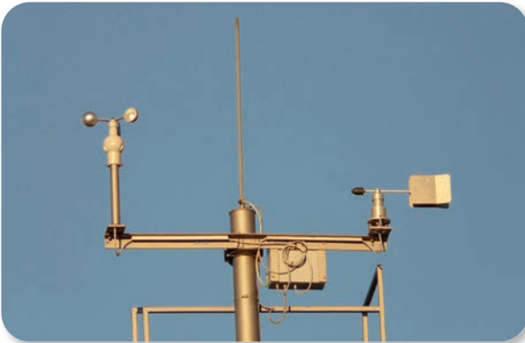
Görsel 1.5: Sabit anemometre elamanları ve jiruet
