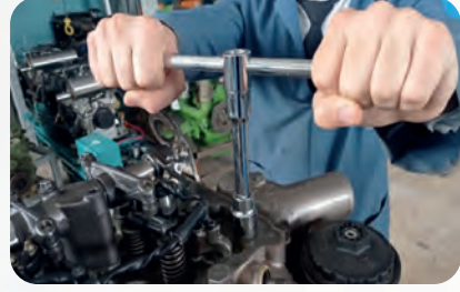
Görsel 1.3: T kol ile cıvata sökme ve takma işlemi
