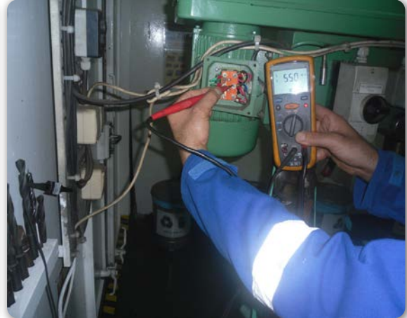
Görsel 5.8: Meger cihazıyla yalıtım direnci ölçümü
