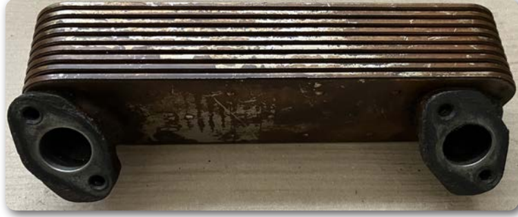
Görsel 1.3: Yağ soğutucu
