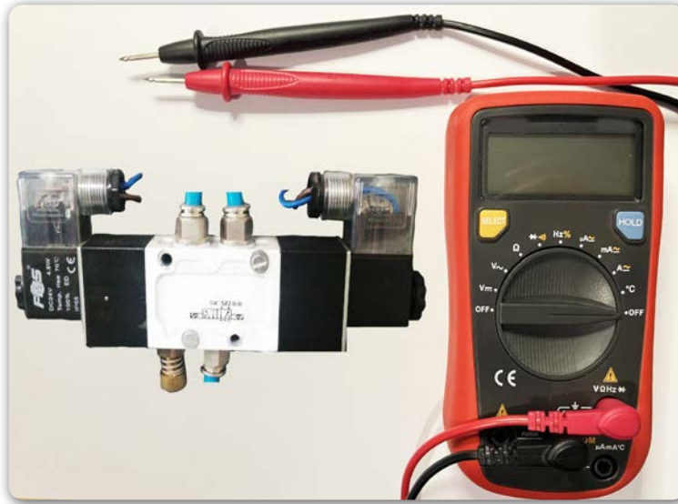
Görsel 4.10: Multimetreyle selenoid valfin bobin kontrolü
