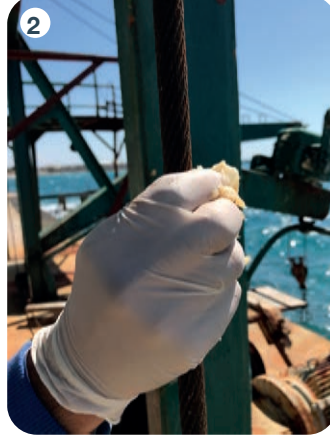
Görsel 5.6: Tel halatı yağlama aşamaları
