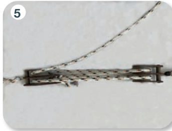
Görsel 4.4: Top palanga oluşturma aşamaları
