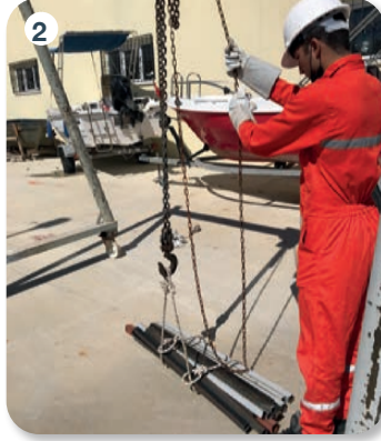
Görsel 4.5: Sapan kullanarak yük kaldırma aşamaları
