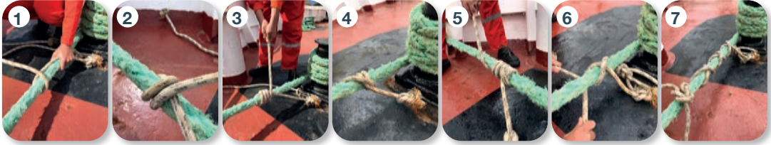
Görsel 2.4: Bosa halatını hazırlama ve bosa vurma aşamaları
