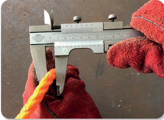
Görsel 2.2: Çap ölçüm aşamaları
