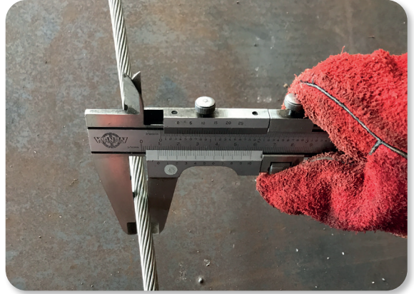
Görsel 2.2: Çap ölçüm aşamaları
