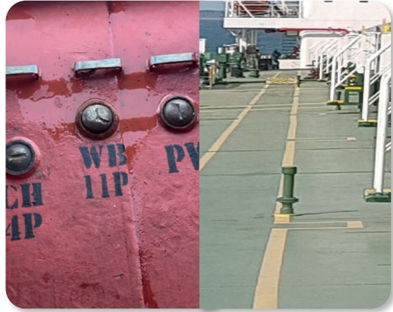
Görsel 1.99: Güverte üstündeki iskandil borusu girişi
