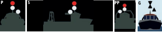
Şekil 10.25: Üzerinde yol bulunmayıp ağ balıkçılığıyla uğraşan ve ağlarının tekneden uzaklığı > 150 m olan bir teknede fenerlerin görünümü
