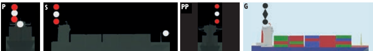
Şekil 10.33: Boyu < 50 m olan, manevrası kısıtlı (mayın temizleme hariç) demirli bir teknede fenerlerin görünümü
