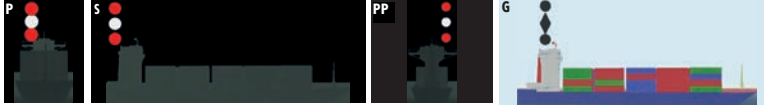
Şekil 10.31: Üzerinde yol bulunmayan manevrası kısıtlı (mayın temizleme hariç) bir teknede fenerlerin görünümü
