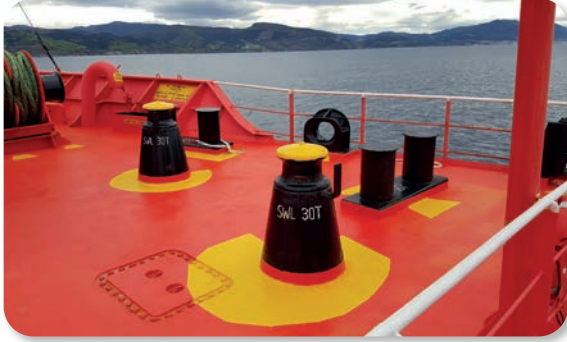
Görsel 1.93: Yönlendirici basamak tamburatası veya fırdöndü
