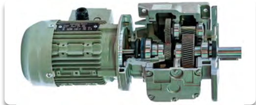
Görsel 8.6: Redüktörlü asenkron motor
