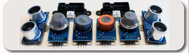
Görsel 9.16: Kontrol kartı ile kullanılan MQ-2 gaz sensörü
