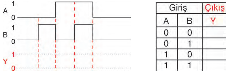
Şekil 4.52: VE (AND) kapı devresi çıkış sinyali dalga formunun uygulama sonuçlarına göre çizilmesi ve doğruluk tablosunun doldurulması
