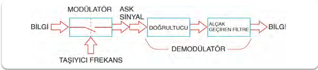
Şekil 7.22: ASK blok diyagramı
