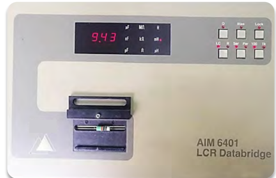
Görsel 1.36: LCRmetre ile endüktans ölçümü
