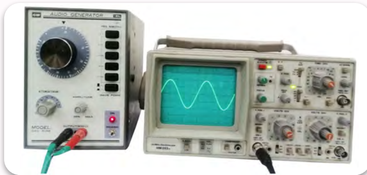
Görsel 1.12: AC sinyalin ölçülmesi
