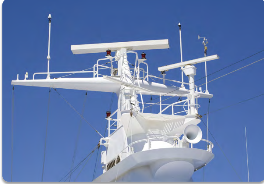
Görsel 10.4: Gemide seyir ve haberleşme cihazlarında kullanılan antenler
