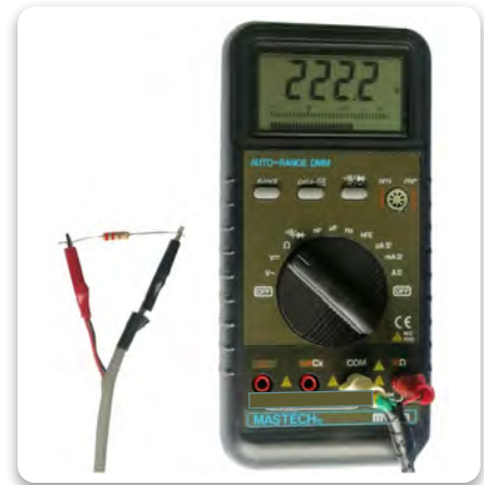
Görsel 1.21: Multimetre ile direnç ölçme
