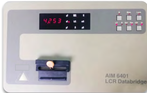
Görsel 1.26: LCRmetre ile kapasite ölçümü
