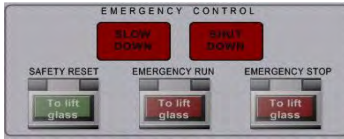
Görsel 1.7: Acil durum kontrol paneli
