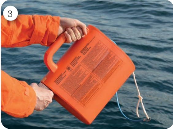
Görsel 4.24: Halat atma aletini kullanma aşamaları
