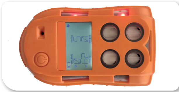
Görsel 1.5: Gaz ölçüm cihazı
