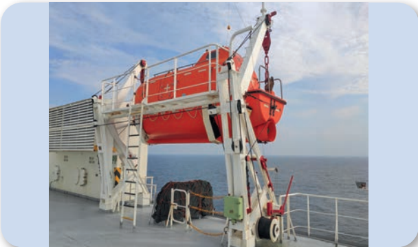
Görsel 5.3: Otomatik maynalı matafora sistemi
