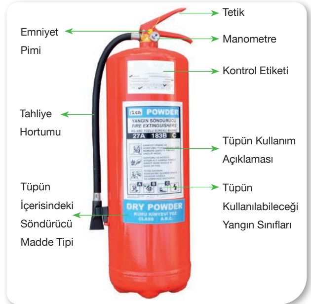
Görsel 3.8: Taşınabilir yangın tüpünün kısımları
