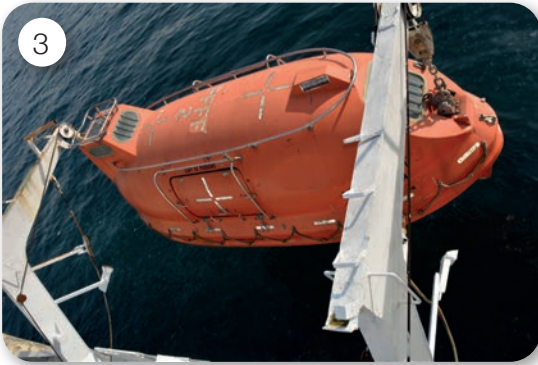
Görsel 5.16: Tam kapalı can filikasının mataforaya alınma aşamaları
