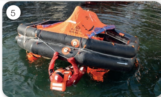
Görsel 5.11: Suda ters açılmış can salını düzeltme aşamaları
