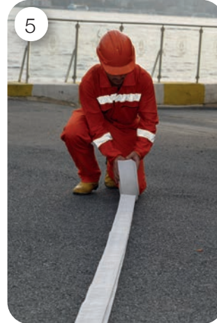
Görsel 3.27: Yangın hortumunu donatma ve geri istifleme aşamaları
