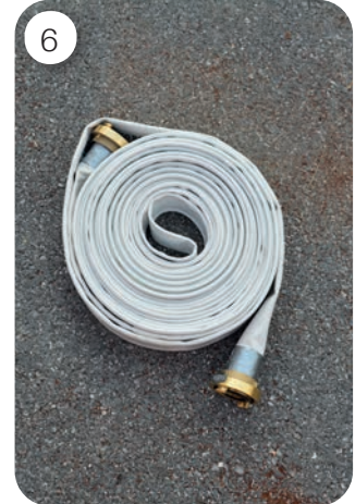
Görsel 3.27: Yangın hortumunu donatma ve geri istifleme aşamaları
