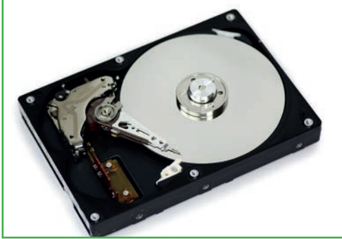
Görsel 3.24: Manyetik diskli sabit sürücü iç yapısı
