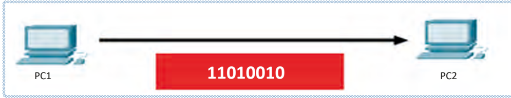
Görsel 1.2: Seri iletişim hattında veri iletimi
