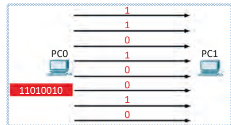
Görsel 1.4: Paralel iletişim hattında veri iletimi
