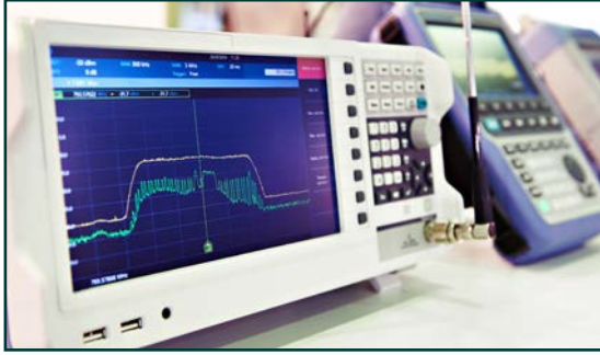
Görsel 1.50: Bir sinyaldeki gürültünün spektrum analizörü yardımı ile ölçülmesi
