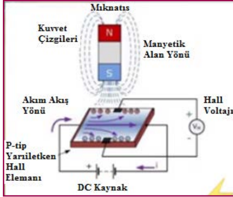
Görsel 3.23: Yaklaşım sensörü çalışma prensibi
