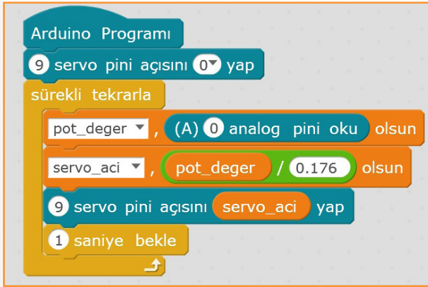
Görsel 8.37 b: Servo motor kullanımı blok kodları
