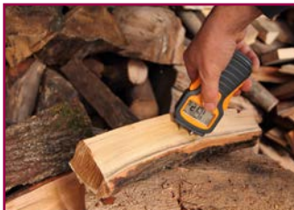
Görsel 3.60: Odunun içindeki nem ölçümü
