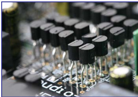
Görsel 6.2: Elektronik kart üzerine bağlanmış transistörler
