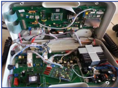
Görsel 7.2: Defibrilatör cihazı iç yapısı
