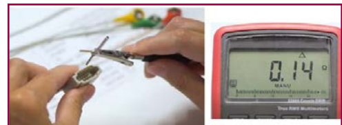
Görsel 3.83: EKG elektrotları bağlantı kablusunun multimetre ile kontrolü
